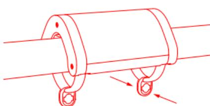
2. 開機後先連續快速按一下2次設定鍵將窗簾伴侶的掛鉤釋放到最長狀態，同時將窗簾拉至完全關閉；
