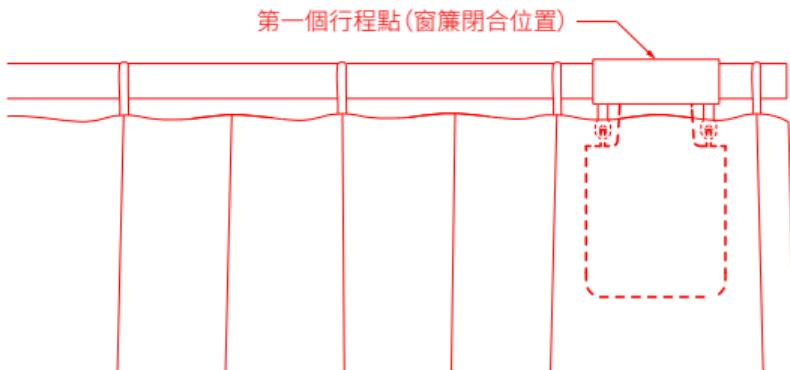
C) 同時窗簾驅動器在全開方向上被拉動約10公分後會自動運行到行程限位點並停止。一聲長「嘩」後，另一個行程限位點自動設置成功，表示設備的開啟範圍設定完畢。
