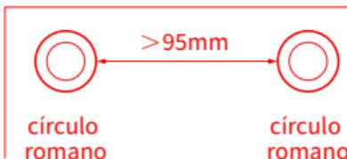
Si utiliza cortinas con anillos, el grosor de las anillos debe ser superior a 4 mm.
