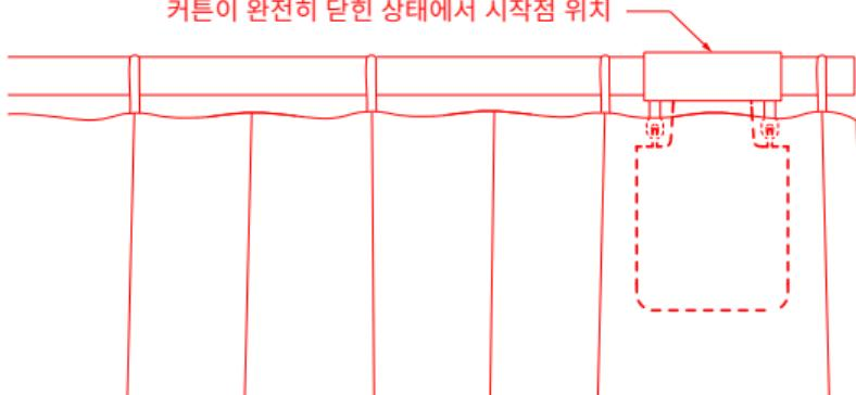
C) 시작점을 설정한 후 커튼이 열리는 방향으로 커튼 드라이버를 약 10cm 정도 손으로 밀어주세요. 커튼 드라이버가 자동으로 커튼이 완전히 열리는 지점까지 이동한 후, 커튼이 마지막으로 열리는 중지점을 자동으로 설정합니다.
