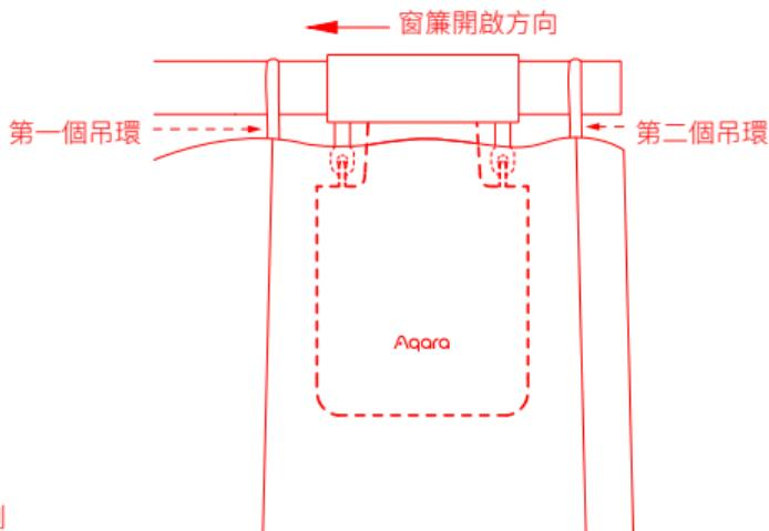
本產品可透過應用程式設定，根據環境光線的強度控制打開和閉合窗簾。使用該功能時，光感測器應朝向窗外安裝，窗簾驅動器應安裝在靠近窗戶側。如需根據室內光線來控制窗簾的開合，則光感測器應朝向室內，窗簾驅動器應安裝在靠近室內側。請確保其前方沒有不透明物體，以達到光感測器的最佳效果。
