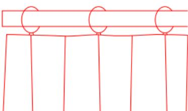
Se si usano tende con occhiello, la distanza minima tra due occhielli deve essere superiore a 95 mm.
