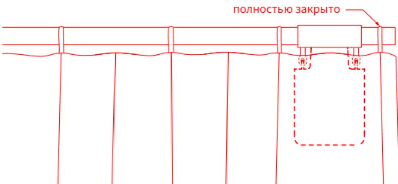
B) Затем быстро нажмите кнопку настройки 3 раза подряд, чтобы установить первую граничную точку диапазона. После длинного звукового сигнала первая граничная точка будет успешно установлена.
