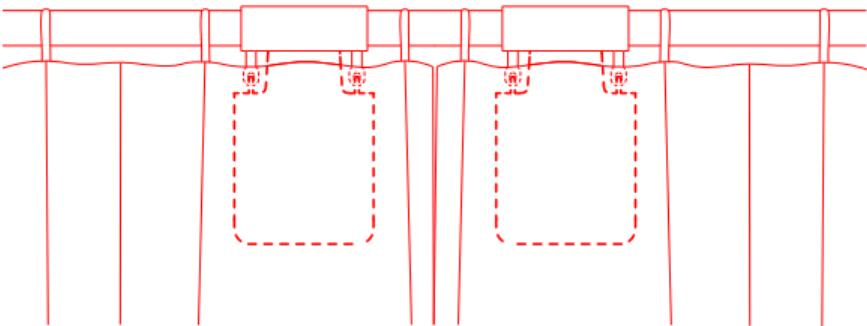
B) Ajuste la distancia de apertura de los controladores de cortina en los lados izquierdo y derecho según el paso B y C de la configuración de apertura para "cortinas de apertura simple".
