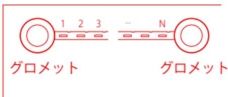
2.最初のクリップを牽引ベルトの左から3番目の穴に取り付け、次の指示に従って残りのすべてのクリップを取り付けてください。
