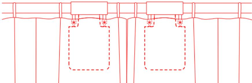
B) 根據「單面窗簾」的B、C步驟設置左右兩側的窗簾驅動器的打開行程。
