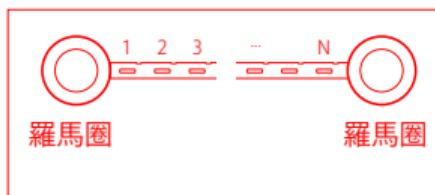
2. 請先將第一個固定夾安裝在牽引帶左起第三個孔位上，並按照接下來的指引安裝剩餘全部固定夾。
