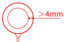
Anforderungen an den Stangen-Durchmesser: 25-32 mm (entspricht Umfängen von 79-100 mm)
