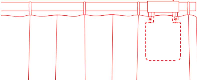
C) Pendant ce temps, le moteur rideau fonctionnera automatiquement jusqu'au point d'ouverture limité et arrêtez-vous après avoir été tiré dans le sens de l'ouverture complète pendant sur 10 cm. Après la longue "bip", un autre point limite est défini automatiquement et avec succès, ce qui signifie que la plage d'ouverture de l'appareil est configurée..
