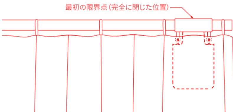
C)同時に、カーテンドライバは自動的に開き制限点まで作動し、全開方向に約10cm引いて停止します。長い間「ピッ」という音がした後、もう一つの限界点が自動的に正常に設定されます。これは、設備の起動範囲が設定されていることを意味します。
