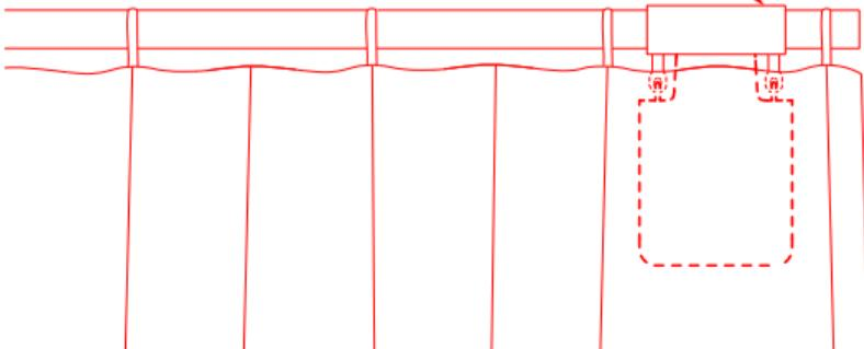
C) Nel frattempo, il Dispositivo di Azionamento per Tende correrà automaticamente fino al punto di limitazione dell'apertura e si fermerà dopo che è stato tirato nel senso di apertura completa per circa 10 cm. Dopo il segnale acustico lungo, un altro punto limite viene impostato automaticamente e con successo, il che significa che l'intervallo di apertura del dispositivo è impostato.
