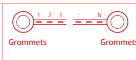
2. Bringen Sie den ersten Clip am dritten Loch von links des Gummi-Streifens an und installieren Sie alle anderen Clips gemäß den folgenden Anweisungen.
