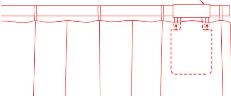
C) In der Zwischenzeit fährt der Vorhangsmotor automatisch bis zur Öffnungsgrenze und stoppt, nachdem er etwa 10 cm in die volle Öffnungsrichtung gezogen wurde. Nach dem langen „Piepton“ wird automatisch und erfolgreich ein weiterer Endpunkt gesetzt, was bedeutet, dass der Öffnungsbereich des Geräts eingestellt ist.
