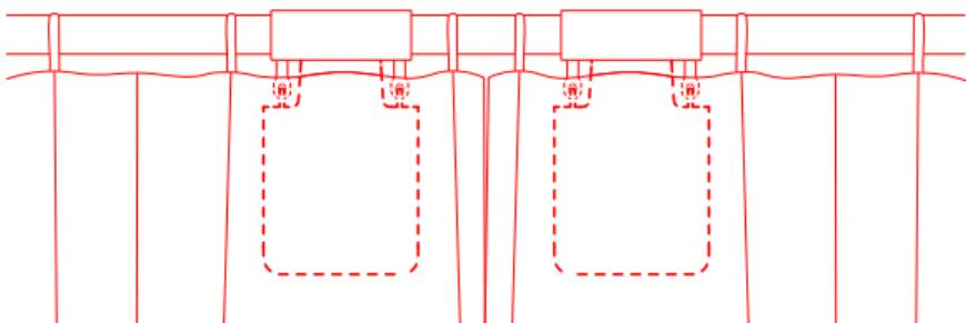
B)「片面カーテン」の手順BとCに従って、左右のカーテンドライバの起動距離を設定します。
