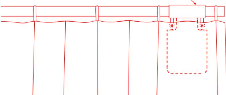
С) Тем временем привод для штор автоматически подойдет к точке ограничения открытия и остановится после оттягивания его в направлении полного открытия примерно на 10 см. После длинного звукового сигнала автоматически будет установлена другая граничная точка, что означает, что диапазон открытия устройства был установлен.
