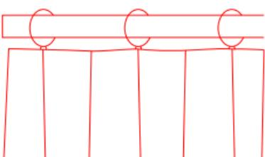
Si vous utilisez des rideaux à œillets, l'espacement minimal entre deux œillets doit être supérieur à 95 mm.
