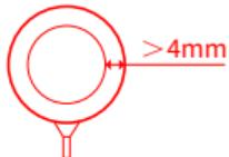
Требуемый диаметр штанги: 25-32 мм (соответствует окружности 79-100 мм)
