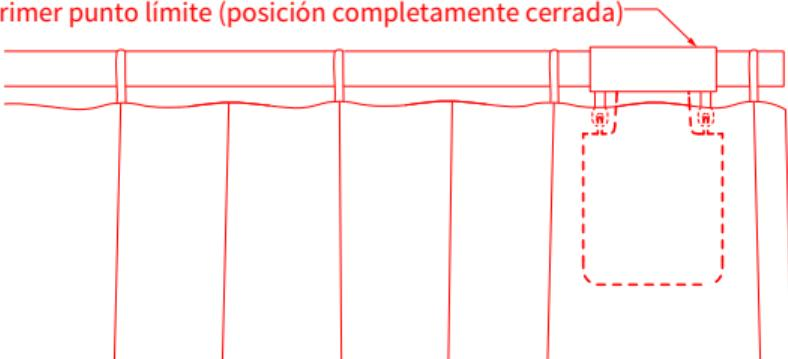
C) Mientras tanto, el controlador de cortina se desplazará automáticamente hacia el punto de apertura límite y se detendrá tras ser arrastrado hasta el punto de apertura total durante al menos los últimos 10 cm de riel. Después de escuchar un "pitido" largo, el segundo tope ha sido configurado con éxito, lo que significa que el rango de apertura del dispositivo ya está configurado por completo.
