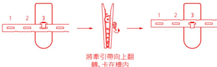
第二個固定夾與第一個固定夾之間留出6個孔位，其它相鄰固定夾之間的孔位數為 $N \times 2$ （包含固定夾本身所佔用的孔位）
