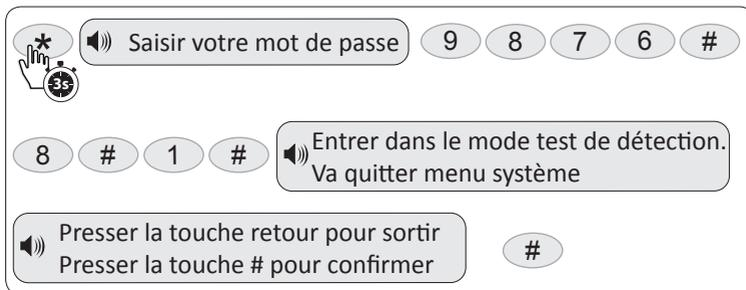
La centrale passe en mode test. Tester les détecteurs en les déclenchant un par un. Pour les détecteurs d'ouverture simuler une ouverture, pour les détecteurs de présence simuler un mouvement. Chaque déclenchement d'un détecteur affiche la zone d'alerte et son statut sur l'écran LCD et fait sonner l'alarme pendant une seconde.
